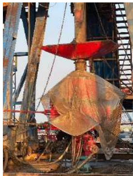
รูปที่ 2-29 อุปกรณ์ป้องกันการพลุ่ง (Blowout Preventer, BOP)
