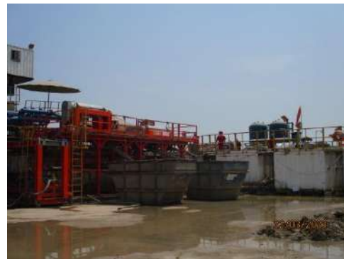
รูปที่ 2-11 ถังเก็บสารเคมี และถังผสมโคลนเจาะชนิด SBM
